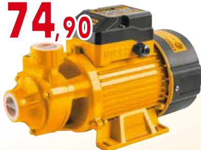
Potenza 750W (1 HP), prevalenza massima 52 mt, portata max 50 lt/min, aspirazione max 8 mt, attacco da 1", girante in ottone.
