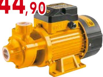
Potenza 370W (0,5 HP), prevalenza massima 35 mt, portata max 35 lt/min, aspirazione max 8 mt, attacchi da 1", girante in ottone.
